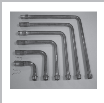
Rohrsatz QR-CC Anschlüsse links und rechts für Q25CCR und Q30CCR für den seitlichen Anschluss links und rechts (Vorlauf, Rücklauf, Kaltwasser, Warmwasser, Gas, Zirkulation) mit 22 mm Kupferrohr, inkl. Übergängen auf 3/4" Außengewinde, Dichtungen und Sicherungsfedern, mit Isolierung
