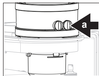
Messpunkt Abgassonde Bild 9.5.a
